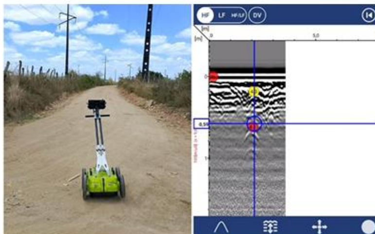
Figura 4 - Localização de registros de manobra com georadar no Povoado Mangueiras
