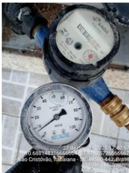
Foto 17 - Medição de pressão no bairro São Cristóvão
