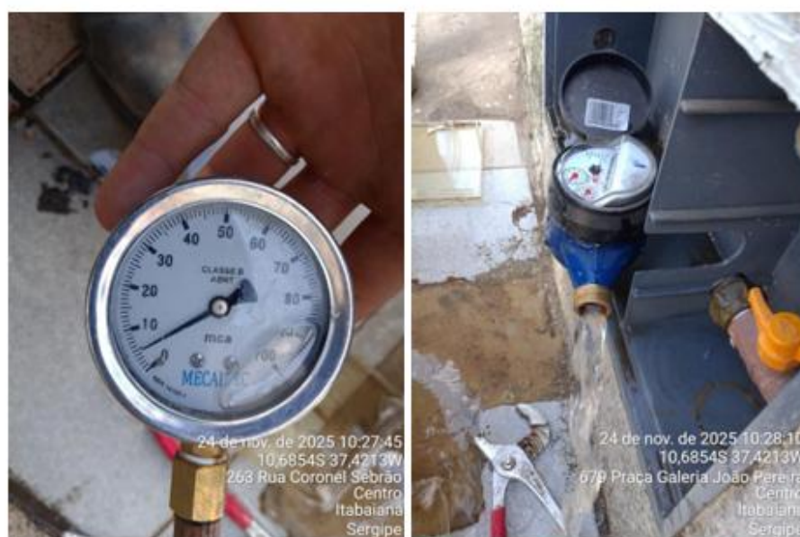
Foto 9 - Medição de pressão no Centro de Itabaiana
