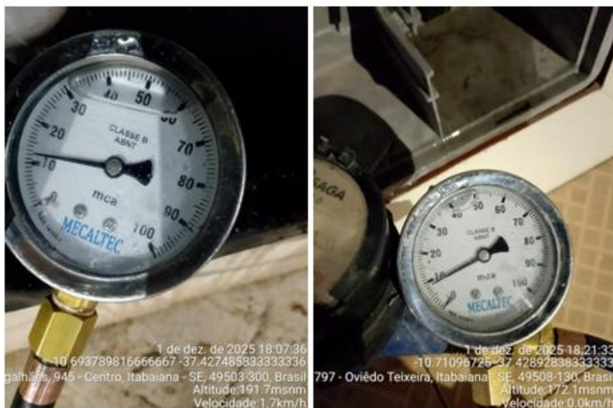
Foto 30 - Medição de pressão nos bairros Centro e Oviêdo Teixeira
